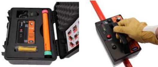
⊕ • Le TTR2 est un appareil portatif, permettant de mettre en évidence des défauts d'isolement électrique ou de propreté sur le matériel, avant chaque utilisation, ou dans le cadre préliminaire du contrôle périodique (minimum requis).
