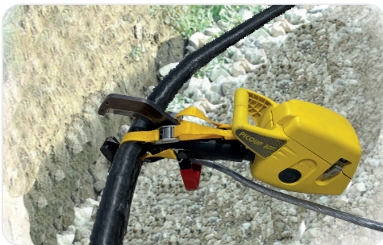
Nueva correa de sujeción al cable para un corte exitoso a control remoto seguro
