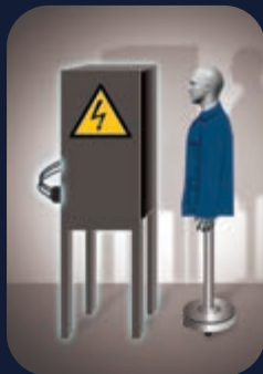
Determinación de la clase de protección de ropa en función de la intensidad de la instalación eléctrica, según 2 clases: Clase 1 (para 4 kA durante 0,5 s a 30 cm) Clase 2 (para 7 kA durante 0,5 s a 30 cm) (principio europeo)
