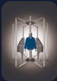
Determinación del valor ATPV de la ropa expresado en calorías/ \text{cm}^2 (principio americano)
